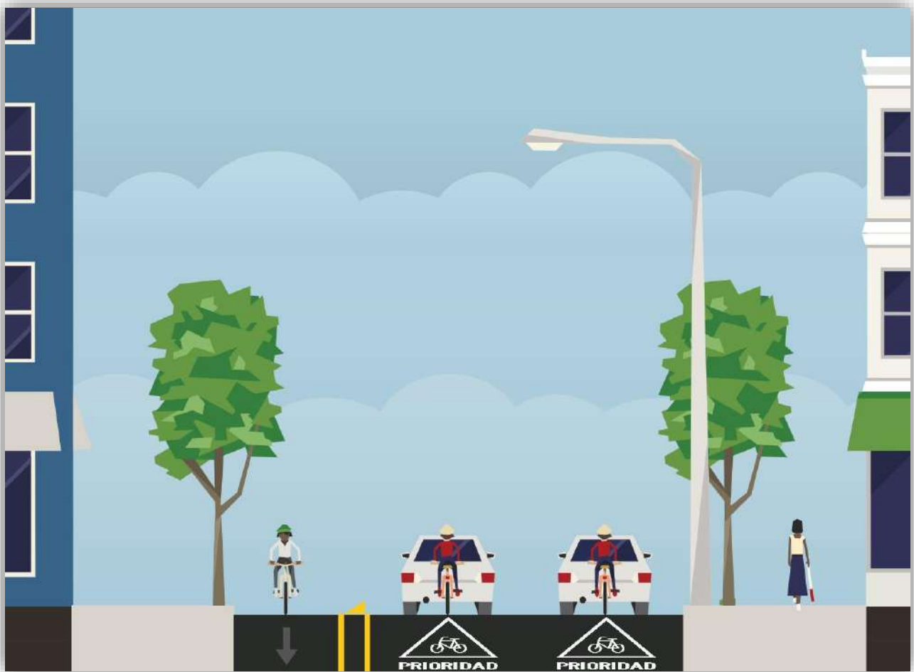
Figura 33. Vía compartida ciclista con ciclovía en contraflujo en vía unidireccional con dos carriles
