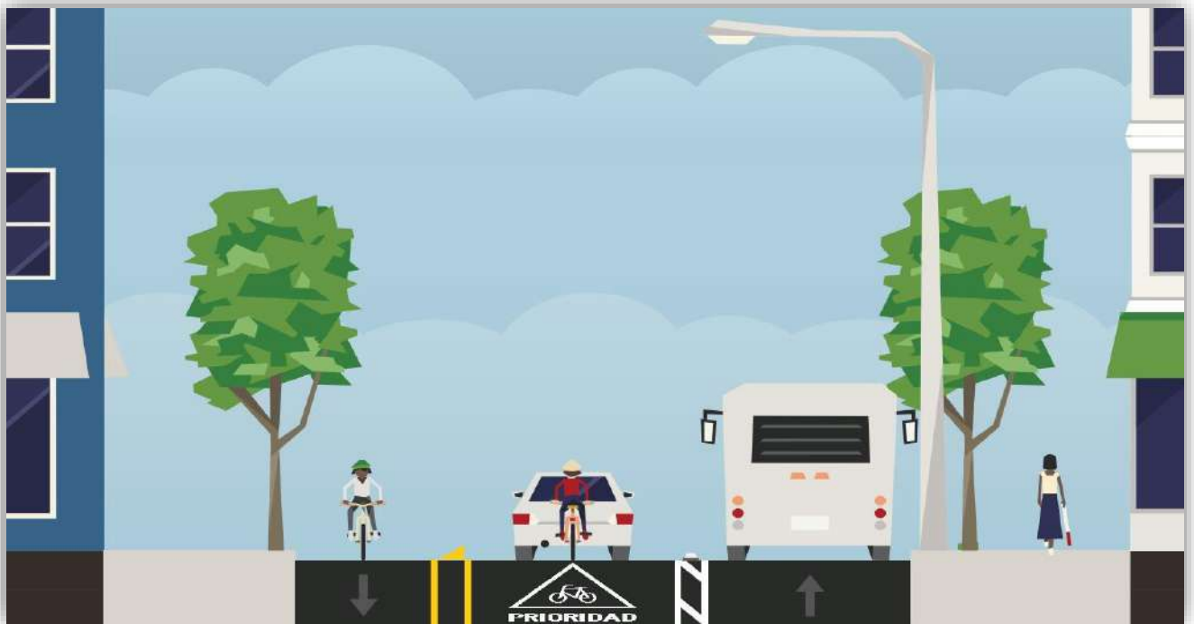
Figura 34. Vía compartida ciclista con ciclovia en contraflujo en vía unidireccional con carril de transporte público
