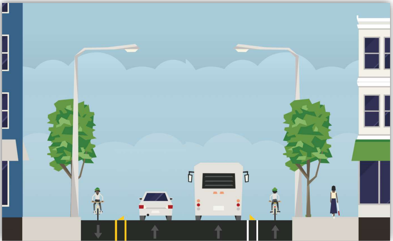
Figura 16. Sección tipo de ciclovía unidireccional y en contraflujo en vía de único sentido
