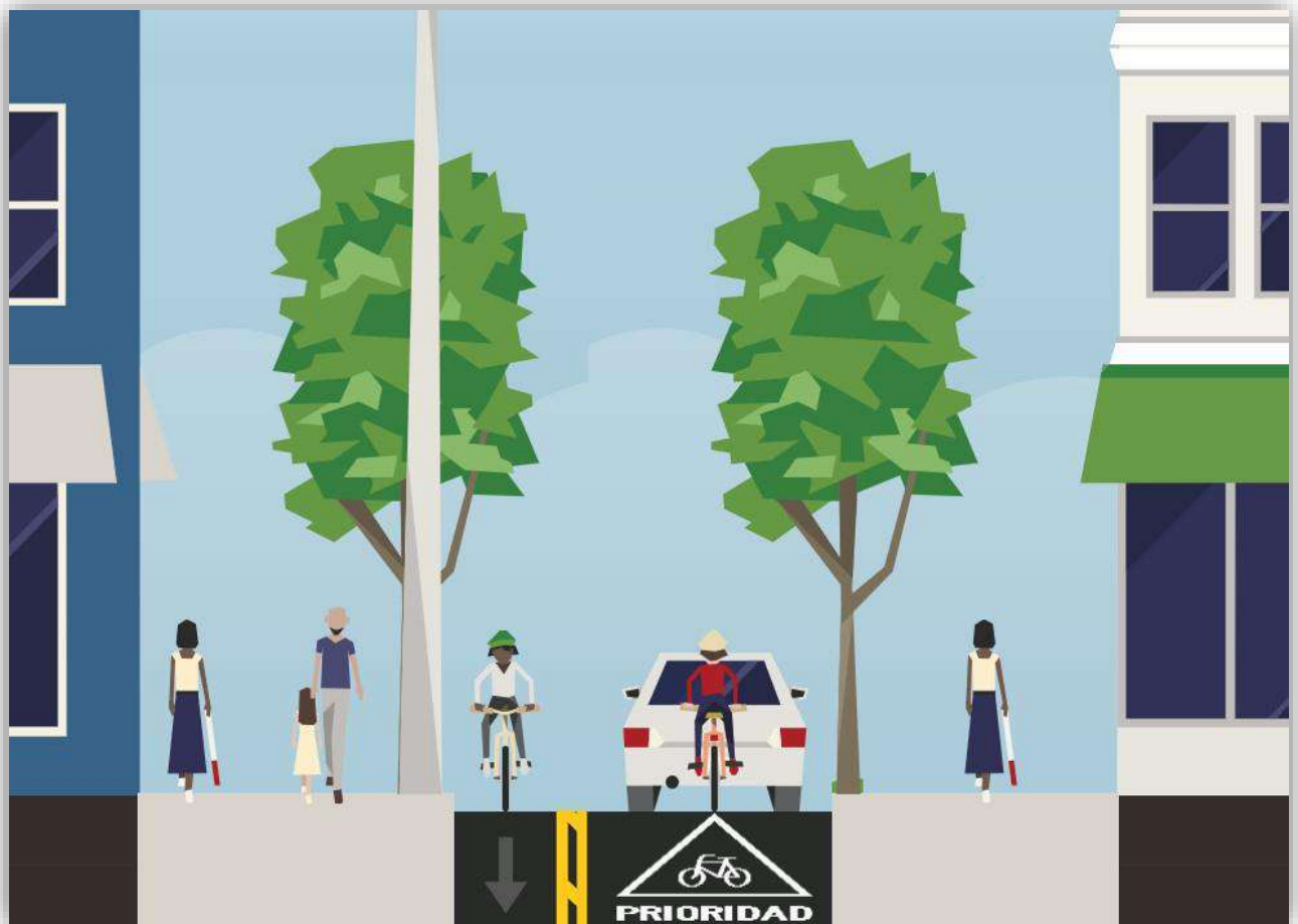
(Continua) Figura 36. Vía compartida ciclista con ciclovia en avenida con carril bus y con separador central
