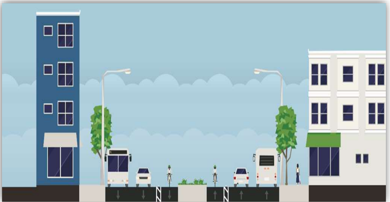
Figura 14. Sección tipo de ciclovía unidireccional al lado izquierdo en avenida de doble sentido con separador central
