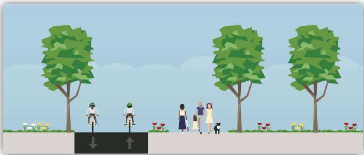
Figura 48. Sección tipo de ciclosenda con flujo peatonal y ciclista mixto
